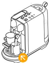
⑤ 确保奶壶底部接触到滴水盘里的感温器。
