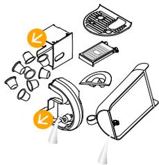
**2** 确保水箱中有水 500ml / 17fl.oz. 滴水盘插入机器。水箱中加入除垢液。
