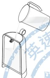
**2** 将**水箱、滴水盘和粉囊盒**安装到**位**。为了安全考虑，请在操作前确保以**安装好粉囊盒和滴水盘**。
