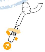
**7 将清洁针放回机器后部。**长按蒸汽按键3秒钟，让蒸汽从喷嘴喷出。
