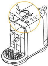
**6** 在咖啡出口下方**放置**一个空**杯子**。按下**Lungo**按键，机器进入**清洗模式**。当运行完成后，**清空容器**。
